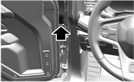
10. Remove the upper hinge bolt.
